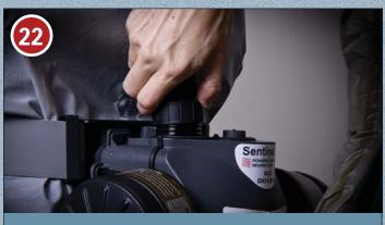
ATTACH THE HOOD TUBING TO THE PAPR MOTOR
